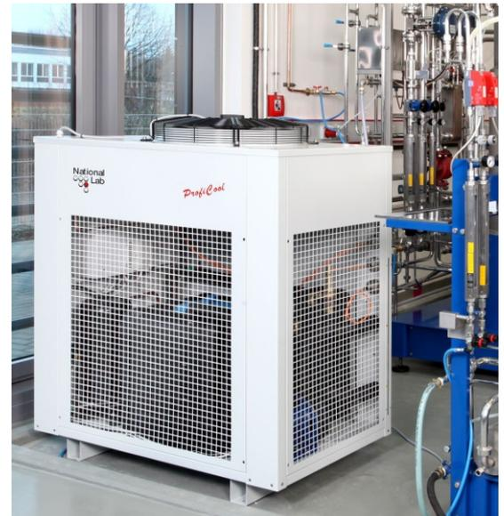
ProfiCool *Genius* Kühlwasser-Rückkühler werden serienmäßig als Einkreissystem mit atmosphärisch offenem Tank geliefert. Durchlaufsysteme ohne Tank und/oder ohne Pumpe für geschlossene Wasserkreisläufe sind selbstverständlich möglich.
